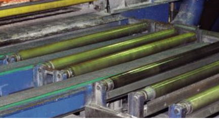
Walsen voor profielen die gevoelig zijn voor transport
