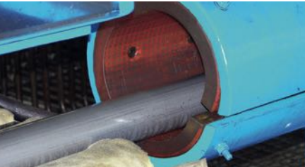
Bekleding van installaties om buizen recht te maken
