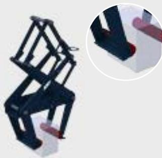
Das Greifen der Last erfolgt über Reibschluss. Reibschlüssige Greifer müssen eine Sicherheit von  $>2$  gegen Herausrutschen
