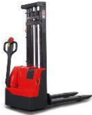
Wendig kommt der EGV Eco um jede Ecke und präsentiert sich als perfektes Einsteigermodell wenn es darum geht, Lasten bis zu 1000 kg elektrisch zu heben und zu verfahren. Die 12V/85Ah Semitraktionsbatterien eignen sich besonders für kurze Einsatzzeiten. Mit integriertem Ladegerät 24V/10A.
