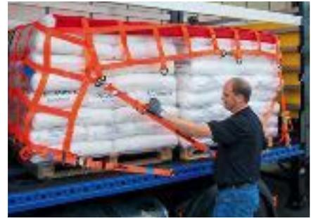
Stückgut wie Pakete und Päckchen lassen sich im LKW mit dem SpanSet-PackNet sichern. PackNet verhindert ein Verrutschen der Ladung, ohne die Kartons durch starkes Niederzurren zu quetschen oder sonst wie zu beschädigen.
