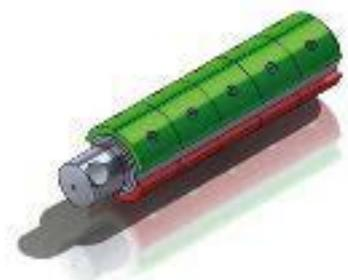
FX Lasthebemagnete: Massive Schaltwelle mit aufgeschraubten Magneten, 90° theoretischer Schaltweg, extrem robust, nur ein Luftspalt.
