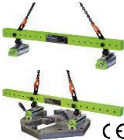
FX-LT Magnettraversen sind den Bedürfnissen von Blechverarbeitern, Laser- und Brennschneidern angepasst. Zwei FX-V Lasthebemagnete und eine leichte Distanztraverse mit Zweistrangkettengehänge ermöglichen das Be- und Entladen von Maschinen mit Blechen, oder das waagerechte Aufnehmen von Werkstücken mit mittigem Ausschnitt. Mit
