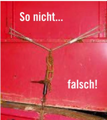
Mulden nur durch Niederzurren zu verzurren, z. B. mit der Y-Zurrung, reicht nicht aus. Eis, Öl, Lehm oder Schmutz reduzieren den Reibungswert auf ca.  $\mu = 0,1$ , auch bei reibungserhöhenden Matten.
