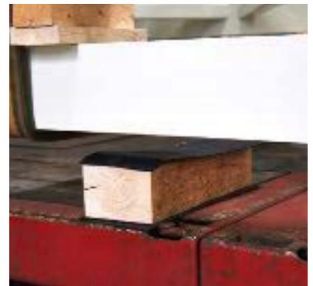
Bei der Ladungssicherung durch Kraftschluss gilt: Je höher die Reibung zwischen Ladung und Ladefläche, desto weniger Zurrgurte brauchen Sie. Ohne Einsatz von Antirutschmatten ist ein wirtschaftliches Sichern durch Niederzurren kaum möglich.
