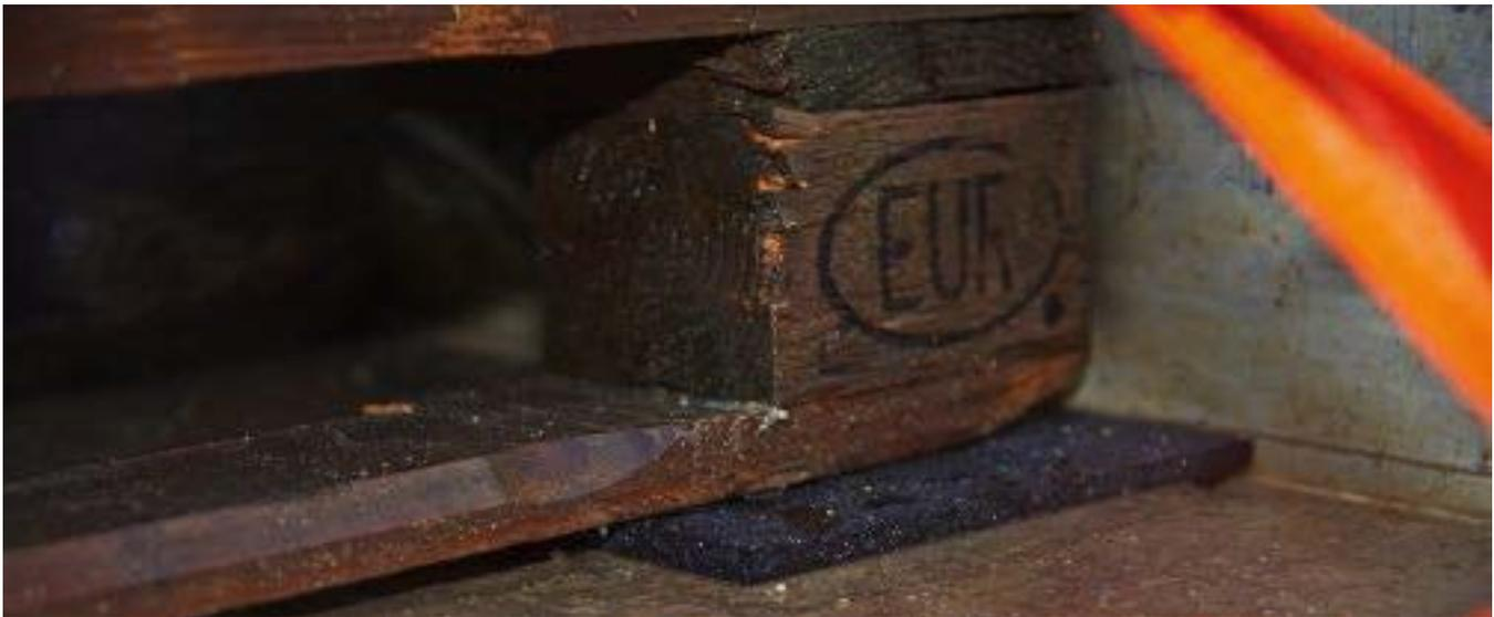
Die Antirutschmatte aus Gummigranulaten wird in gleichbleibend hoher Qualität gefertigt, entspricht der VDI 2700ff und ist universell einsetzbar. Für die gängigen Materialpaarungen werden Reibwerte von  $\mu$  0,6 und mehr erreicht und durch Prüfzertifikate dokumentiert. Bei der Herstellung werden Gummigranulate in definierter Qualität und Größe unter Druck zu Antirutschmatten verklebt und verarbeitet. Über die Standardanschnitte hinaus
