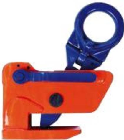
Die horizontalen Hebeklemmen IPHØ - IPHØ eignen sich zum Heben und Transportieren von Stahlblechen (auch für sich durchbiegende Bleche). Die IPHØ -Hebeklemme lässt sich in geöffneter und geschlossener Stellung verriegeln. Durch ist eine sichere Handhabung gewährleistet, deshalb auch beim Verschicken von Abkantbänken, Blechscheren, Blechrundbiegemaschinen usw. verwendbar.
