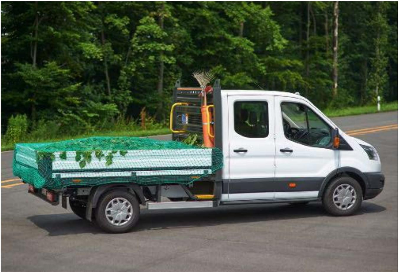
Die PaXafe-Abdecknetze sind DEKRA-zertifiziert und mit einem fest angenähten Kennzeichnungsetikett versehen.
