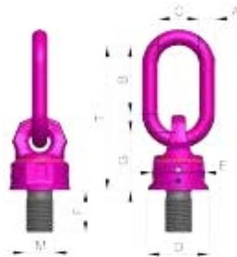
**i** Achtung: VWBG sind nicht für Dauerdrehbewegungen unter Last geeignet! Nicht unter 90° mit Volllast drehbar!
