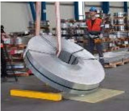
Wenn feste Einrichtungen, wie Wendetische, nicht zur Verfügung stehen, dann werden Coils und große Maschinenteile meist mit einem secutexSchutzschlauch gewendet. Bei diesem Wendevorgang „rollt“ die untere Kante der Last auf dem Boden ab. Auf einem glatten Untergrund kann die schwere Last unkontrolliert wegrutschen. Schäden an den wertvollen Werkstücken sind sehr häufig nicht zu vermeiden.
