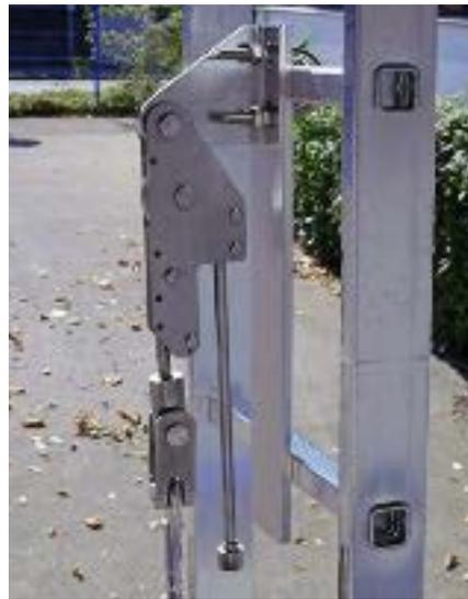
Systemfalldämpfer am oberen Befestigungspunkt
