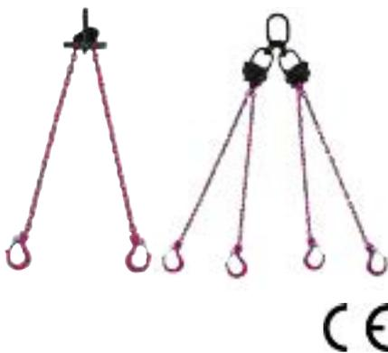
Beim Typ **V** ist jeder einzelne Strang **verkürzbar!** In dieser Ausführung wird die Kette umgelenkt, Sie benötigen also bei zwei Strängen für einen Meter Nutzlänge zwei laufende Meter Kette.
