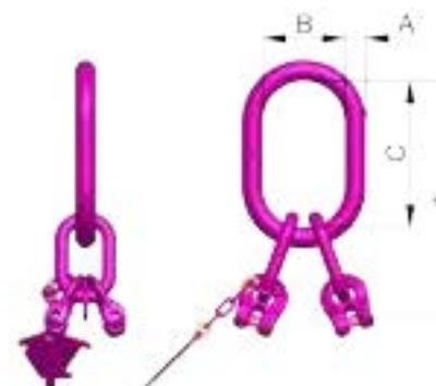
VAK 4-Strang Aufhängekopf mit 4 eingeschweißten, allseitig beweglichen Ringgabeln -VRG-, dadurch Zwangsanschluss für Ø-Kette und Strangzahl. Der VIP-Aufhängekopf ist mit dem RUD ID-POINT® (RFID-Chip) ausgestattet und kann über die eindeutige Identifikationsnummer zugeordnet werden.
