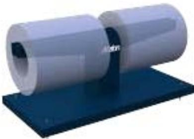
Es müssen Spaltbänder vor der Verarbeitung aus ihrer Verladeeinheit vereinzelt werden. Bei werden sie meist liegend vorgelagert, um sie dann einzeln entnehmen. Die mit einem separaten Kippstuhl gewendeten Spaltbandpakete werden mit einem großen Coilhaken zum Ablagegestell transportiert und dort vereinzelt.
