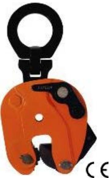
Das **Modell JPA** ist eine Vertikal-Tragklemme für das 180°-Wenden einer einzelnen Platte oder eines einzelnen Teils aus der Horizontalen in die Vertikale. Mit einer zusätzlichen Druckastensverriegelung. Erlaubt die seitliche Belastung der Aufhängeöse bis 90 Grad durch Reduzierung der Nennkapazität der Tragklemme. Tragfähigkeitsreduzierungen entnehmen Sie bitte der Abb. 1.
