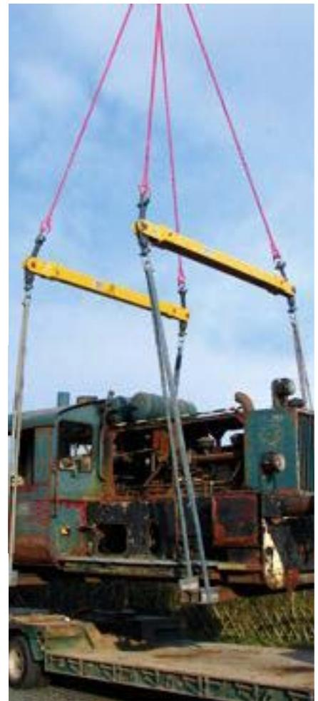
Arbeitsbereich durch Teleskopierung verstellbar. Durch die gelenkige Anordnung der Anschlagbleche erfährt die Traverse ausschließlich Druckkräfte und keine Biegung. **Die Traverse hat hierdurch ein geringes Eigengewicht bei maximaler Leistungsfähigkeit.** Kombination von drei Traversen, bei der zwei  $\varnothing$  tertraversen an einer  $\varnothing$  ertraverse angehängen werden, sind möglich.
