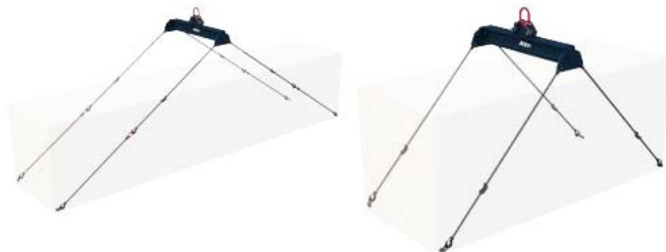
Robuste Traverse geeignet für das Heben von 20" oder 40" ISCC Containern. Kranseitig mit Vario-Aufhängung, lastseitig ausgerüstet mit 2x 2 Güteklasse 10 Ketten mit Containerhaken.
