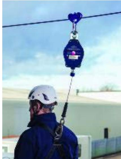
Die SpanSet-Höhensicherungsgeräte sichern z. B. in Kombination mit einer Anschlageinrichtung bei Wartungs- und Montagearbeiten. Die integrierte Falldämpfung bremst und hält die zu sichernde Person beim Fall sicher fest. Die Höhensicherungsgeräte ohne Rettungshub sind am Gehäuse mit einem Twistlockkarabiner ausgestattet und somit direkt einsatzfähig.
