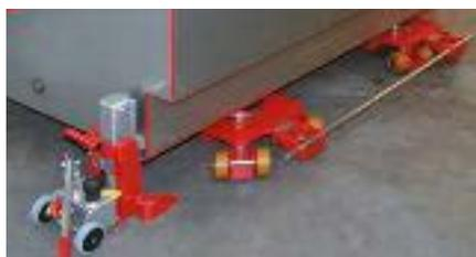
FM.I F.035 in Verbindung mit hydraulischem Hebegerät
