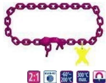
**i** Eine typische „Direktzurr-Ladung“ ohne Zurrpunkt sind Steinblöcke oder Fertigbetonteile. Hier kann mit einer Kranzkette ein sogenanntes „Kopf-Lashing“ angewendet werden.
