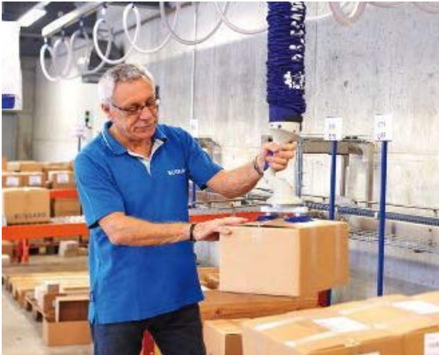
Mit dem Vakuum-Schlauchheber JumboFlex bewegen Sie leichtere Güter bis 50 kg ergonomisch und in hoher Taktfähigkeit. Sein Bediengriff liegt gut in der Hand und ermöglicht langes ermüdungsfreies Arbeiten. Über die zentrale Ein-Finger-Steuerung heben, senken und lösen Sie die Last intuitiv.
