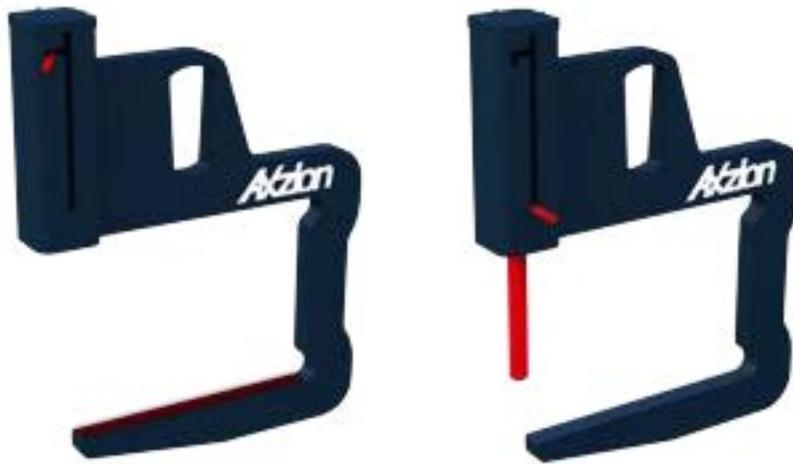
Bei im Transport von Spaltbändern ist eine zusätzliche Sicherung erforderlich. Bei im Einfahren in die Last wird der Schiebolzen in der oberen Position arretiert, beim Transport der Spaltbänder verhindert der Bolzen das Herauskippen der schmalen Gabel.
