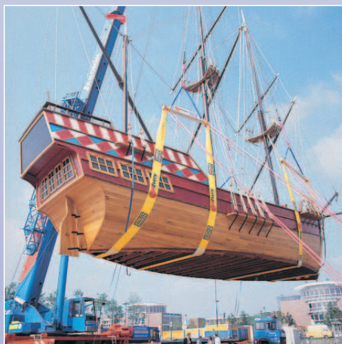
18-ti tunový trojstěžník je položen autojeřábem na vodu.
