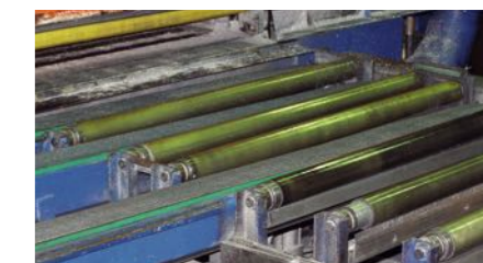
Válce pro přepravu citlivých profilů
