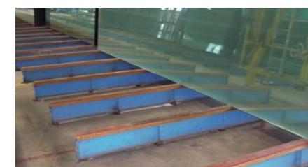
Ochrana podkladu pro skleněné podstavce
