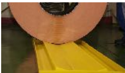
rohož na odkládání svitků s vnitřní vanou na zachytávání oleje
