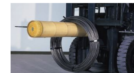
Potrubní moduly pro trny vysokozdvíhacích vozíků
