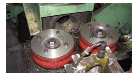
Vysokým teplotám odolné a prořezávané zatahovací role
