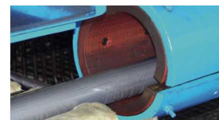
Obložení linky na srovnávání trubek
